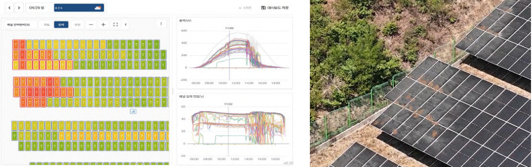
오염으로 인한 발전저하 추적 (경북 상주, 490kW)
