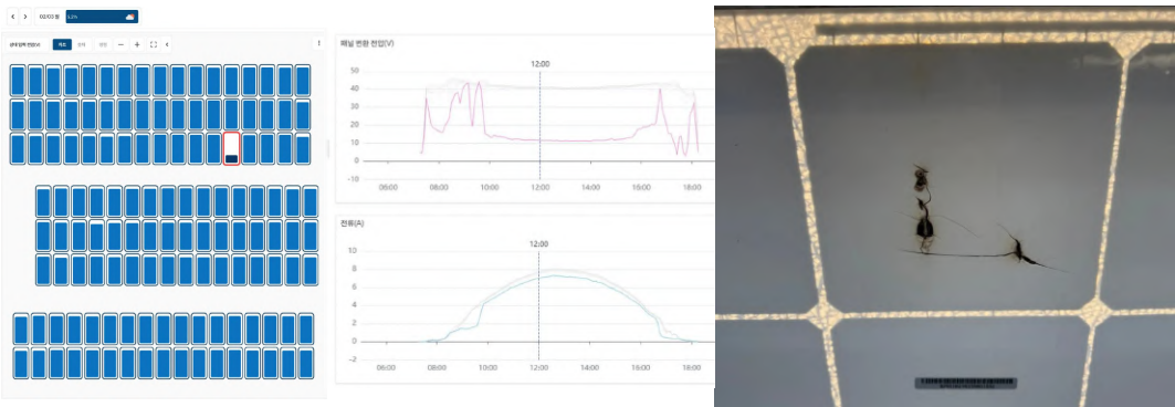
셀 파손으로 인한 누전위험 추적 (경북 상주, 49kW)
